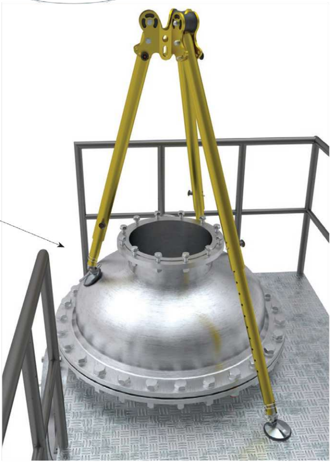
Exemple d'implantation de l'XTRAPOD sur une cuve en acier inoxydable.
